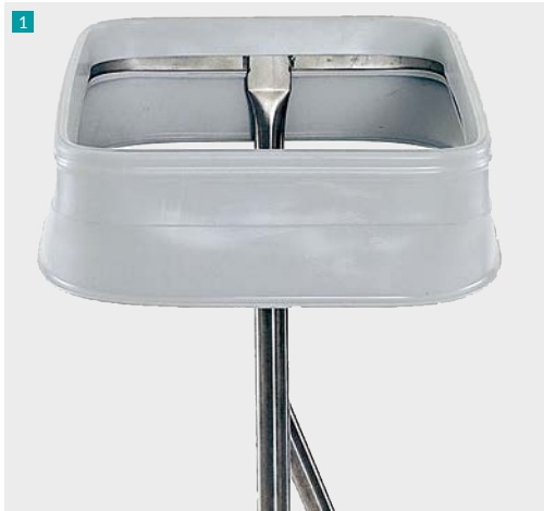
Spannring des Haftringes nach unten klappen.
